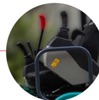
**Interrupteur de sécurité du conducteur**
