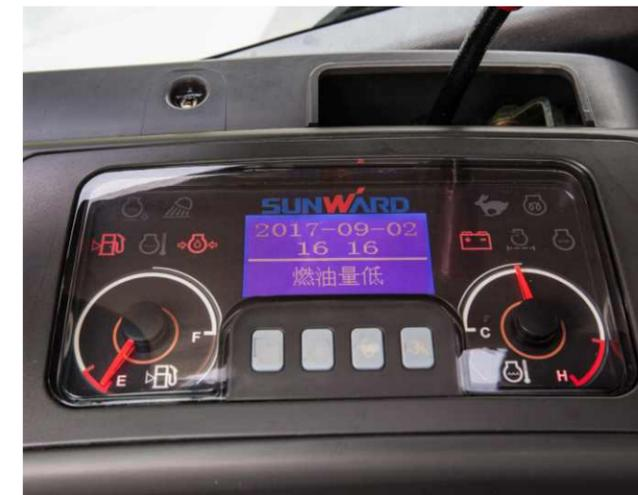
Le rare instrument intelligent à LED est capable d'afficher non seulement la date, les heures de travail, le niveau d'huile et la température de l'eau, mais d'intégrer également les fonctions de commutation à double vitesse de déplacement, de commande des phares de travail et d'afficher une partie des défauts.
